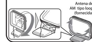
Movimente a antena de AM tipo loop (fornecida) até obter a melhor recepção.
