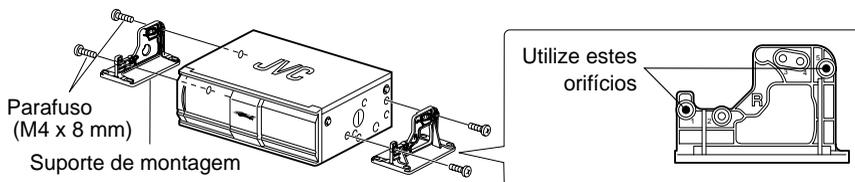
2. Fixe o aparelho no piso do porta malas utilizando os parafusos auto-atarraxantes.
