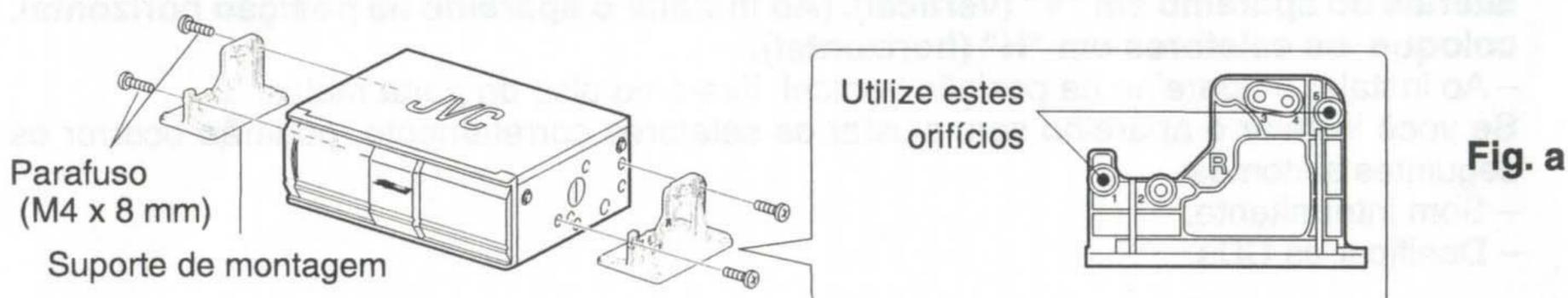
2. Fixe o aparelho no piso do porta malas utilizando os parafusos auto-atarraxantes.
