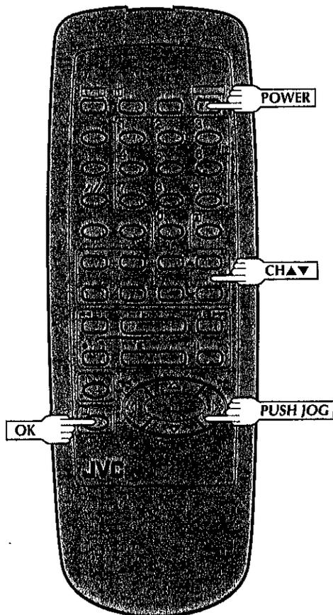
A função Preparativos Fáceis simplifica a instalação, servindo como guia dos procedimentos de ajuste do relógio e dos canais do sintonizador — basta seguir os menus na tela que aparecem quando a tecla **POWER** é pressionada pela primeira vez no videocassete após a inserção do plugue de força em uma tomada da rede elétrica.
