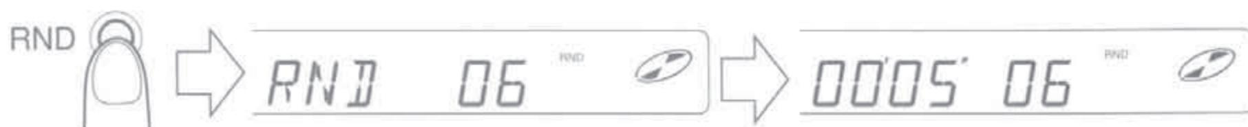
O microprocessador do KD-GS727 seleciona automaticamente as faixas de um CD em ordem aleatória. Para isso, aperte a tecla RND durante a reprodução. Pressionando-se essa tecla novamente, a função é cancelada.
