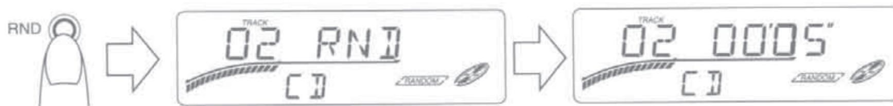
O microprocessador do KD-GS929 seleciona automaticamente as faixas de um CD em ordem aleatória. Para isso, aperte a tecla RND durante a reprodução. Pressionando-se essa tecla novamente, a função é cancelada.
