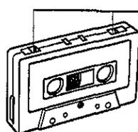
Orifícios de detecção de uma fita de metal (ou cromo)
