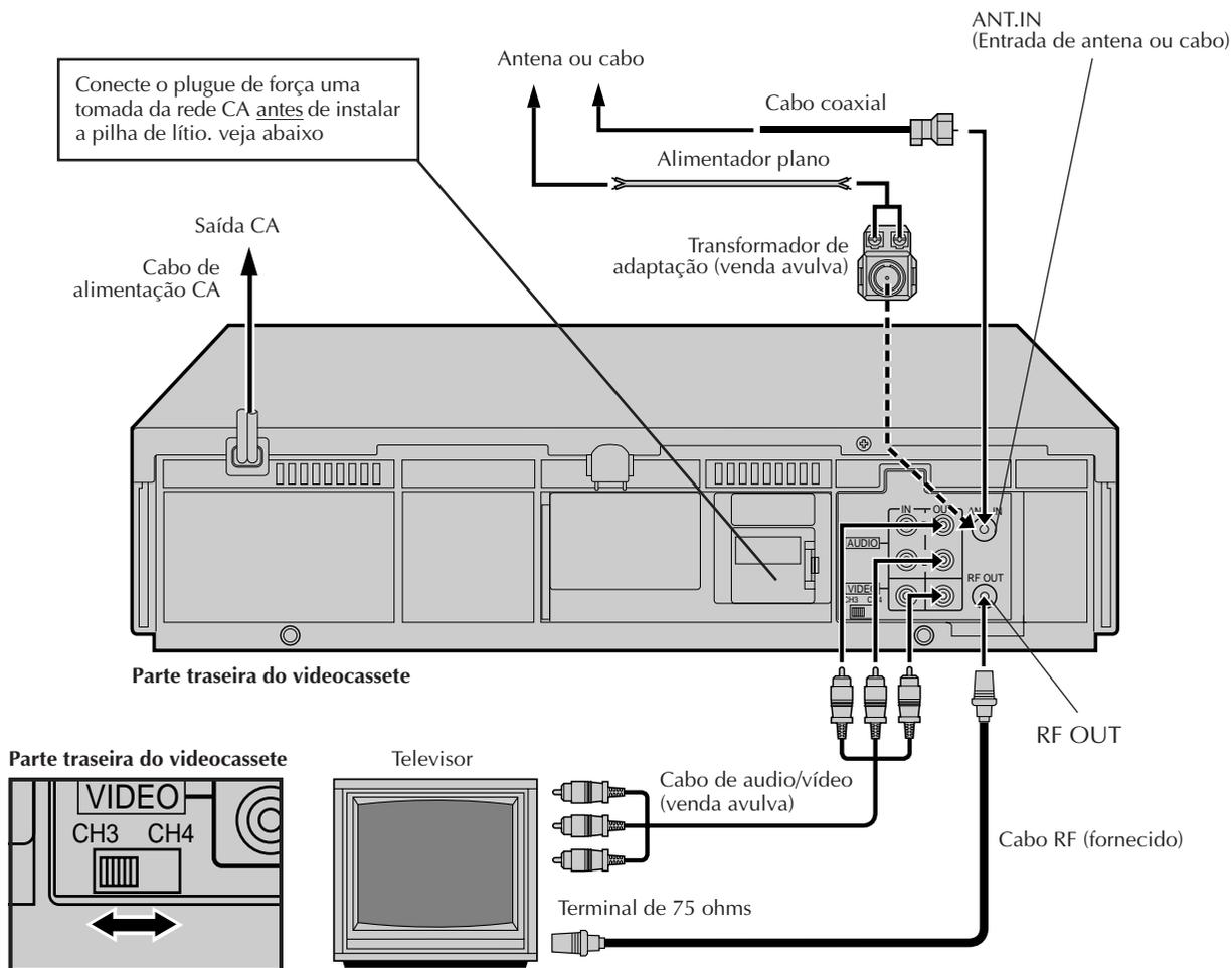
Certifique-se de conectar o plugue de força a uma tomada da rede elétrica primeiro, antes de instalar a pilha de lítio; do contrário, a vida útil da pilha será drasticamente encurtada.
