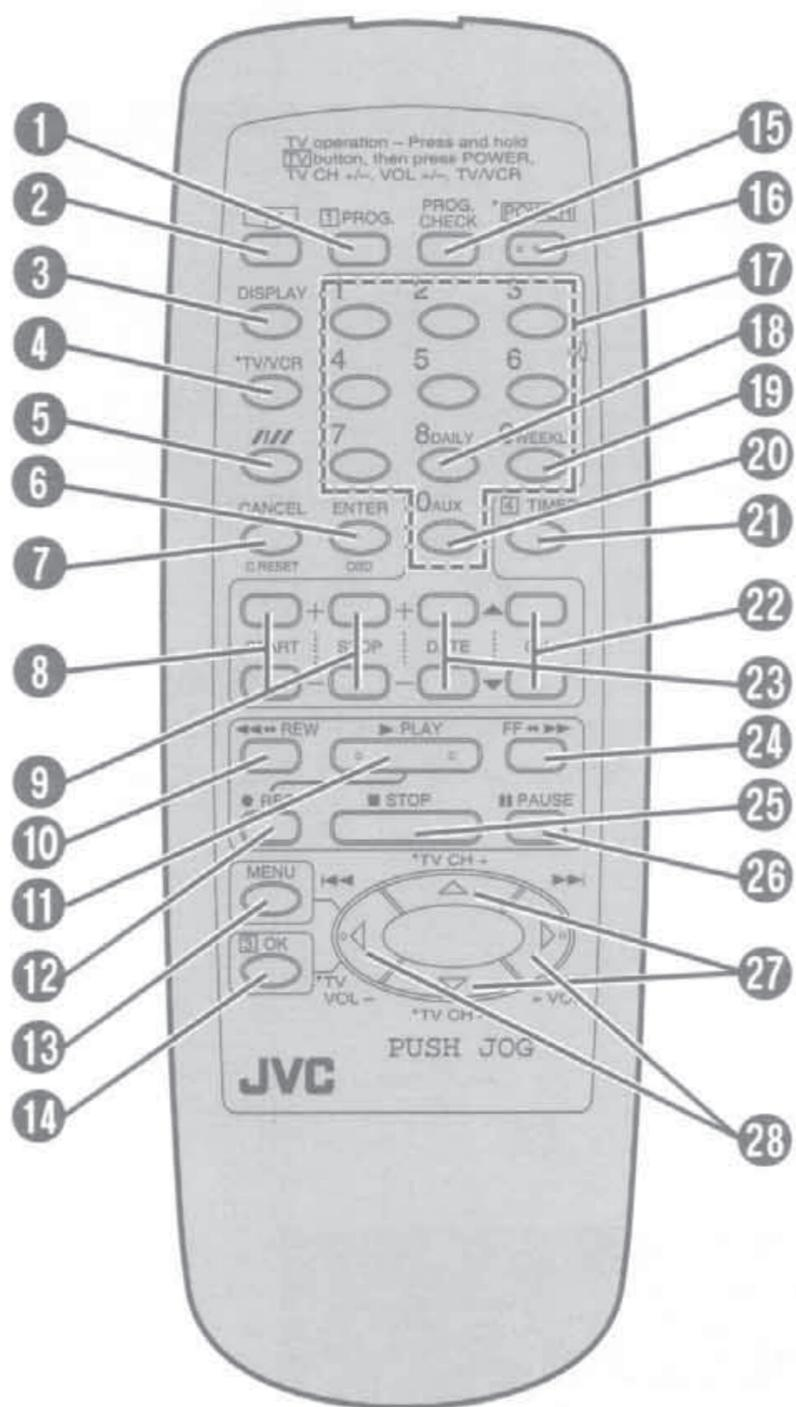
Teclas com um pequeno ponto no lado esquerdo do nome podem também ser utilizadas para operar o seu televisor JVC enquanto se mantém pressionada a tecla **TV**. Z "Operação de televisores JVC" abaixo.
