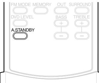
Se não houver operação por 3 minutos enquanto o disco estiver parado, a alimentação será automaticamente desligada.
