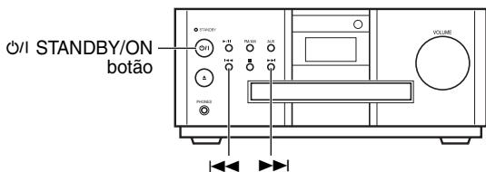
Para selecionar intervalos de 10 kHz, enquanto mantém pressionado ►► na unidade principal no modo de espera, pressione Ø/I STANDBY/ON na unidade principal para ligar a alimentação. “10 kHz” aparece no visor.
