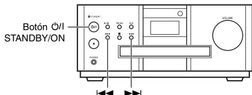
Para seleccionar intervalos de 10 kHz, mantenga pulsado ►► de la unidad principal en modo Standby y pulse O/I STANDBY/ON de la unidad principal para encender la alimentación. En la pantalla aparecerá "10 kHz".
