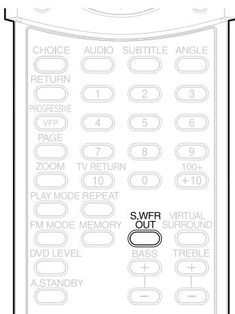
Si desea escuchar el sonido procedente del altavoz de subgraves, pulse el botón **S.WFR OUT** del mando a distancia; a continuación en el visor de la unidad principal aparecerá el mensaje “SUB WFR ON” (altavoz de subgraves activado). Cada vez que pulse el botón, la indicación del visor alternará entre “ON” (activado) y “OFF” (desactivado).
