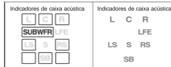
Quais luzes indicadoras de caixa acústica dependem do ajuste da caixa acústica (para obter detalhes, veja "Ajuste das Caixas Acústicas" na página 23).
