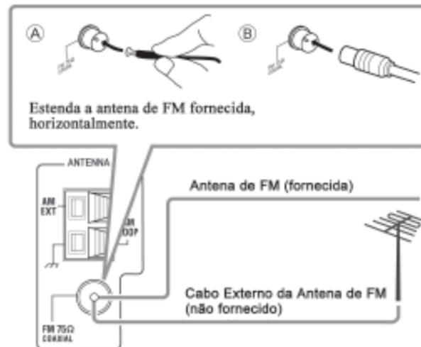
Conecte a antena de FM fornecida, como medida temporária, ao terminal COAXIAL DE 75 Ω de FM – ②.
