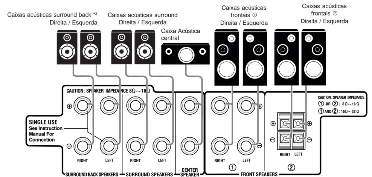
\*2 Quando estiver utilizando apenas uma caixa acústica surround back, conecte o cabo ⊕ ao terminal RIGHT ⊕ e o cabo ⊖ ao terminal LEFT ⊖.
