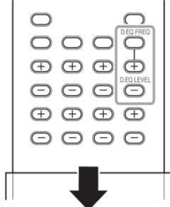
1. Pressione D.EQ. FREQ. (Frequência Digital de Equalização) repetidamente para selecionar a frequência que se deseja ajustar.
