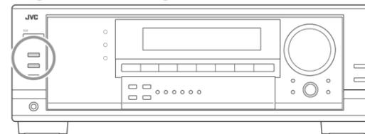
Para utilizar as caixas acústicas conectadas nos terminais FRONT SPEAKERS ①, pressione **SPEAKERS ON/OFF 1 de modo a acender o indicador SPEAKERS 1 no visor.**
