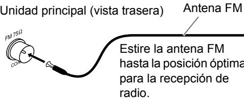
Estire la antena FM hasta la posición óptima para la recepción de radio.
