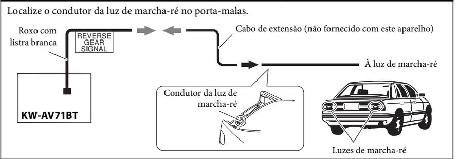
**Antes de conectar:** Verifique cuidadosamente a fiação elétrica no veículo. Uma conexão incorreta pode causar sérios danos a este aparelho. Os condutores da fiação elétrica e os do conector da carroçaria do carro podem ter cores diferentes.
