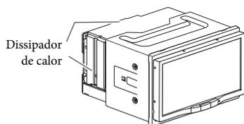
**PRECAUÇÃO:** Instale este aparelho no console do seu carro. Não toque nas partes de metal deste aparelho durante e logo após o uso do aparelho. As partes de metal, tal como o dissipador de calor e a caixa ficam muito quentes.
