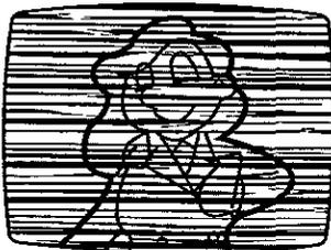
O acúmulo de sujeira e outras partículas nas cabeças do vídeo podem fazer com que a imagem reproduzida fique embaçada ou interrompida. Embora este modelo seja equipado com um limpador interno de cabeça, que automaticamente limpa as cabeças, reduzindo assim a probabilidade de cabeças sujas, consulte o seu revendedor JVC mais próximo se for encontrado esse tipo de problemas.
