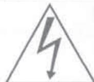
O símbolo do raio dentro de um triângulo alerta o usuário quanto à presença de "tensão perigosa" na parte interna do aparelho que pode ser forte o suficiente para constituir um risco de choque elétrico.
