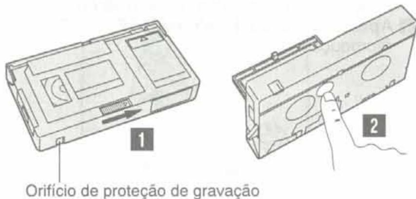
Usando-se o Adaptador de Cassete fornecido (Playpak VHS: C-P7U), pode-se reproduzir uma fita de vídeo VHS gravada com esta câmera em qualquer gravador de vídeo VHS. Quando for instalada uma fita VHS-C no adaptador de cassete, ela é totalmente compatível tanto para gravar como para reproduzir em qualquer gravador de vídeo VHS. O adaptador de cassete C-P7U é operado com bateria e executará o carregamento e descarregamento da fita automaticamente.
